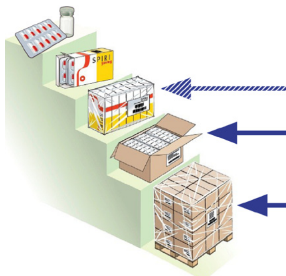
Abbildung 1: Verpackungskaskade (nach ISO/DTS 16791-2012)
