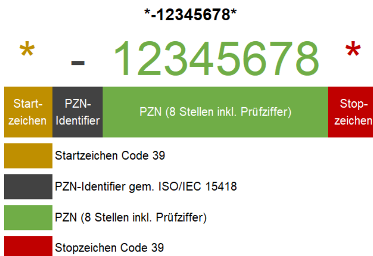
Abbildung 2: Datenstruktur zur Darstellung der PZN im Code 39
